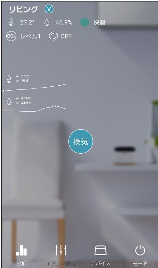
CO<sub>2</sub>濃度が1000ppmを超えると換気運転を開始します。
