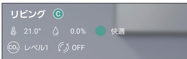
◆ ネットワーク経由で接続すると、エアコン本体の室内温度・湿度センサーを利用して制御を行います。湿度表示が0.0%と表示されている機種の場合、デバイスを設置していないお部屋では湿度を利用した人工知能制御はできません。
